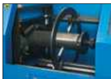
带胶管的双刮齿工具。
