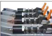
带有可调节旋转头的轴向可 调快速更换系统。
