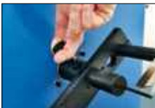
使用 USM 10 S 上的锁定销轻松更换刮削工具。
