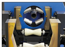
Spanneinheit mit Laufrollen für bis zu 5 Zoll-Schläuche.
