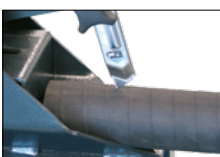
Das SSG Schlitzgerät hält die Schälspäne kurz bis 2".
