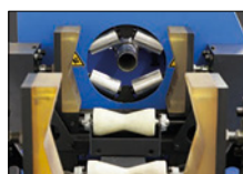
Spanneinheit mit Laufrollen für bis zu 5 Zoll-Schläuche.
