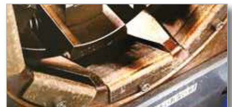
Gleitlager im Zustand nach ca. 900.000 Pressungen
