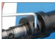
Leichtes Einstellen der Schälanlage.
