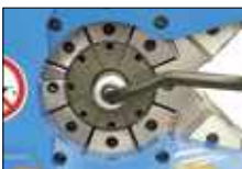
Radiale Zuführbarkeit der Werkstücke auch für 90°-Bögen.
