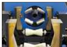
Spanneinheit mit Laufrollen für bis zu 5 Zoll-Schläuche.
