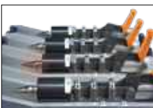
Axial verstellbares Schnellwechselsystem mit justierbarem Drehkopf.
