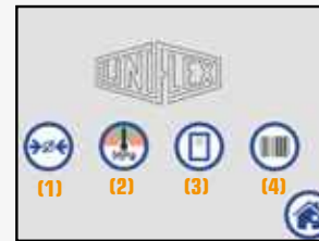
Mehr Parameter, um komfortabel Serien zu verpressen. Auswahlmenü für Pressen per Pressmaß oder Druck durch Produktionsdaten aus der Datenbank oder per Auslesen mit dem Barcode-Scanner
