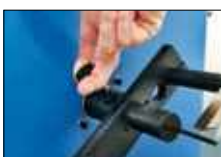
Einfach zu wechseln durch Rastbolzenverriegelung bei der USM 10 S.
