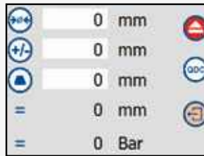
Eingabe von Pressmaßdurchmesser, Korrekturwerten und Pressbacken (automatisch)
