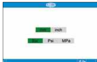
Im grünen Bereich wird die aktuell eingestellte Maßeinheit angezeigt. Durch Antippen einer Taste wird die entsprechende Maßeinheit eingestellt.
