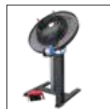
Schlauchwickeltisch UWT 2 + Längenmessgerät UMS 4
