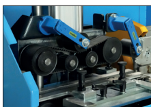
Antriebsraupe für schonende und dennoch zuverlässigen Schlauchvortrieb
