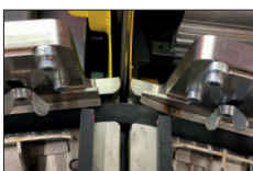
Vorbiegung des Schlauchs und ein bewegliches Schneidmesser für perfektes Schneiden
